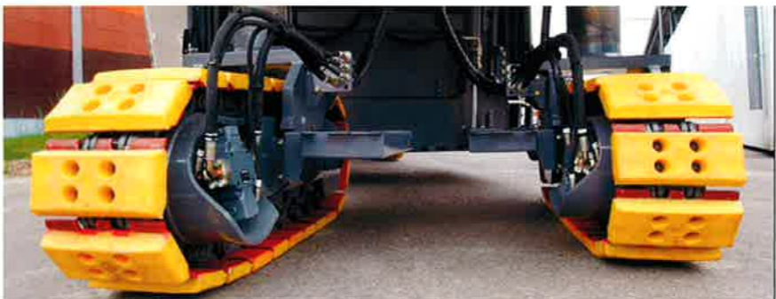
クローラ前後は独立・連動切替式操舵になっており、最小旋回半径も2,400mmと小さく、方向転換もスムーズに行うことができます。
