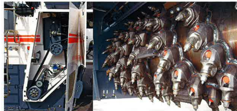
新型クイックチェンジホルダHT11R (国際特許取得済)
